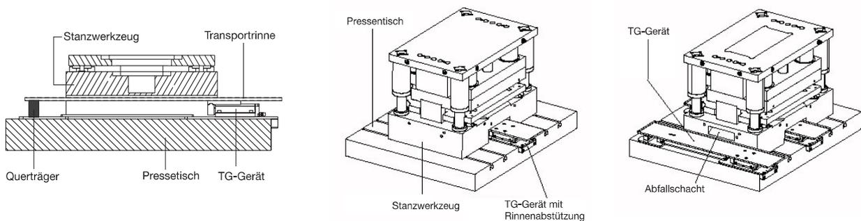
Schnitt durch ein Stanzwerkzeug mit Abfallschacht und TG-Gerät mit Rinnenabstützung.
