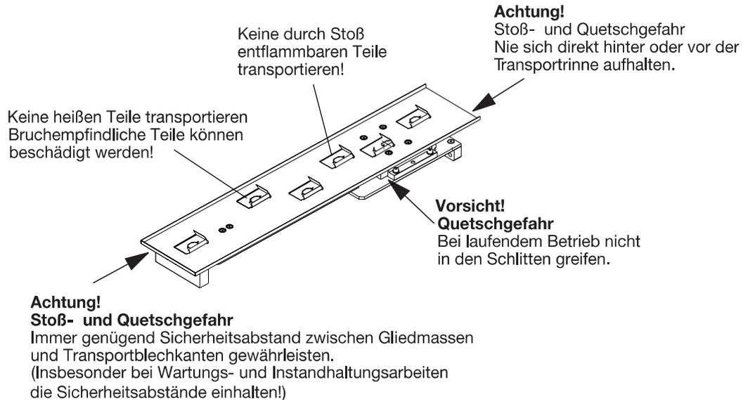
Die Geräte müssen so in der Presse (Werkzeug) eingebaut werden, dass Sie durch Schutzeinrichtungen, wie Schutzgitter, abgeschirmt werden.
